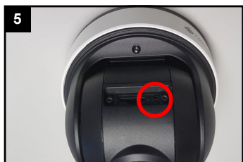
Für Reset: Fünf Sekunden lang die Taste gedrückt halten.
