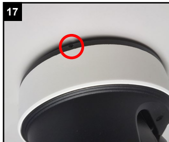
Feststellschrauben an beiden Seiten festziehen und Halt der Kamera prüfen.
