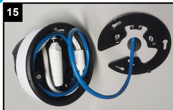
Kabel unter Montagefläche aufwickeln und Kamera an die Montageplatte setzen.
