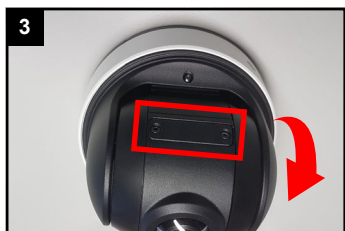
Kamera ein wenig neigen und die Abdeckung lösen.
