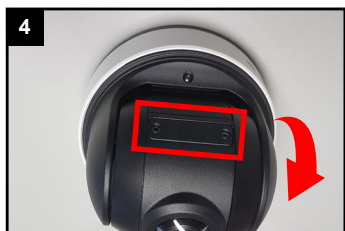
Derunter befinden sich Reset-Taste und Kartenslot.
